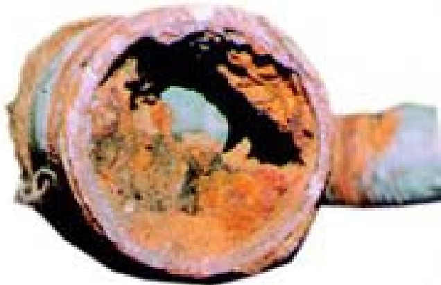
Beispiel eines extrem verrosteten Rohrs
